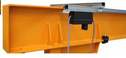
stacionární ovládání na otočném jeřábu (náhradní ovládání)
